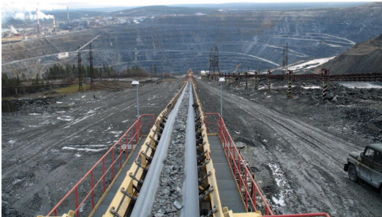
Породный дробильно-конвейерный комплекс ЦПТ
