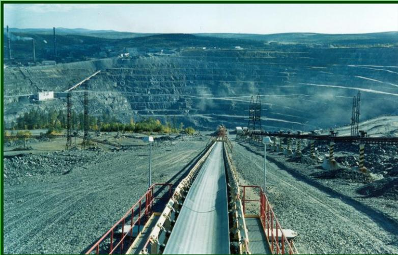
На Ковдорском горнообогатительном комбинате впервые построен и введен в действие **в холодном исполнении** комплекс циклично-поточной технологии по транспортировке вскрышных пород в отвал.
