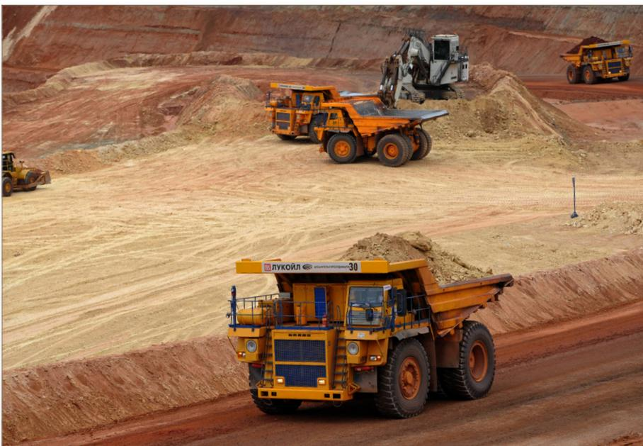
внутрикарьерных дорог. При отсутствии вблизи месторождений щебня, пригодного для строительства дорог, такое решение дает существенную экономию. На предельном контуре борт формируется уступами высотой 30 метров. Весь объем вскрышных пород располагается в двух отвалах к югу и востоку от карьера. Транспортировка руды на фабрику и пород в отвалы предусматривается самосвалами БелАЗ 75131 грузоподъемностью 130 тонн.
