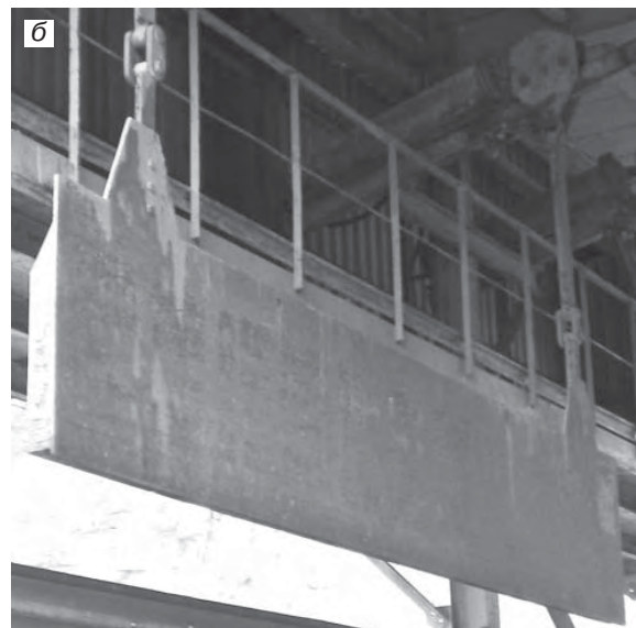
Рис. 2. Пальцевый затвор и лоток (а), отбойный щит (б) узла выпуска горной массы из бункера в нерабочем положении
